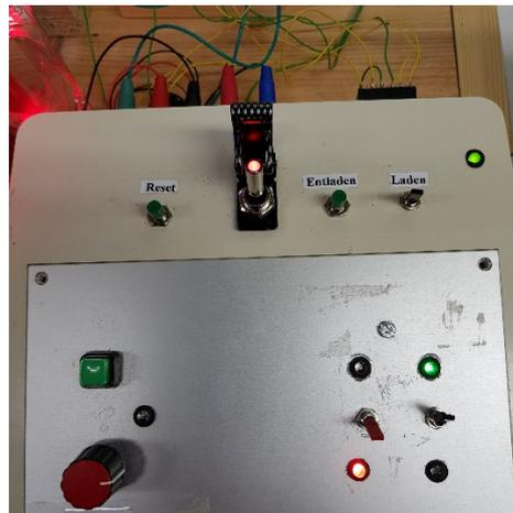
Zentrale Steuereinheit mit Startknopf (grün), Lade und Entladefunktion der Kondensatoren sowie separate Schaltung der beiden Beschleunigungsspulen.
